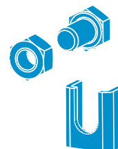
attacco di messa a terra per bullone M12
